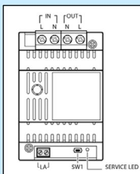
**OH/MPE6KW:** устройство измеряет нагрузку в однофазной цепи максимум до 6 киловатт, предоставляя мгновенную информацию, так что система может контролировать нагрузки и профиль потребления. Поэтому оно предотвращает отключение магистрального питания и управляет почасовым потреблением. Может устанавливаться в коробки с DIN рейкой (размерность 4 DIN единиц).
