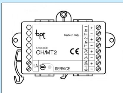
**OH/MT2:** устройство с 2-мя аналоговыми входами для 0-10В датчиков влажности и 2-мя специальными входами для температурных датчиков. Может замерять значения температуры и влажности и передавать их системе по шине. Может устанавливаться в коробки с DIN рейкой или во встраиваемую коробку на 3 или более модулей (размерность 1 DIN единица).
