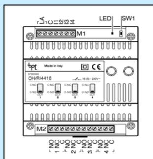
**OH/RI4416:** устройство управляет до 4 силовыми реле 16А с возможностью включения реле вручную при аномалиях.
