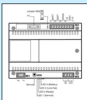
**OH/AS:** устройство запитывает все устройства подсоединенные к шине домашней автоматике Врт, даже если нет магистрального питания (например, в случае системе требуется вспомогательное питание переменного тока). Два аккумулятора OH/V065 могут присоединяться к OH/AS, который активирует их при недостатке магистрального питания и подзаряжает при наличии одного. Может устанавливаться в коробки с DIN рейкой (размерность 8 DIN единиц).
