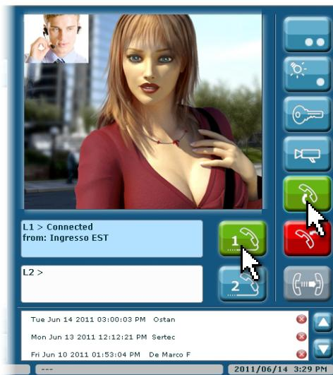
**RU** Для ответа на вызов и активации аудио связи сзывающим пользователем нажмите клавишу "ответ" или клавишу вызываемой линии.
