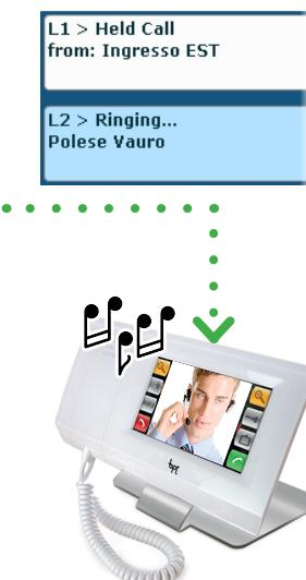
**RU** После перевода вызова в режим ожидания, выберите из списка нужного абонента, на которого будет переадресован вызов (используйте при необходимости окно "поиск") (рис. 3) и выполните вызов (рис. 4); Вызов будет отображен в окне Л2>.
