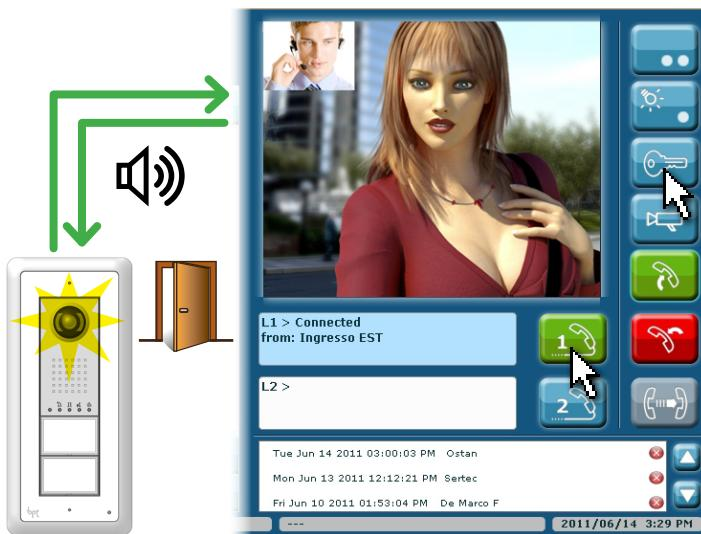
**RU** При активном подключении к вызывной панели (с аудио\видео или аудио) нажатие клавиши открывает замок двери.
