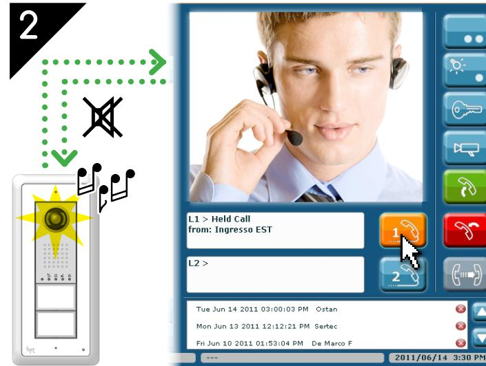
**RU** При активном вызове (рис. 1), нажмите клавишу активной линии, чтобы перевести вызов в режим ожидания (рис. 2), вызывающий (у абонентского устройства или вызывной панели) услышит мелодию.
