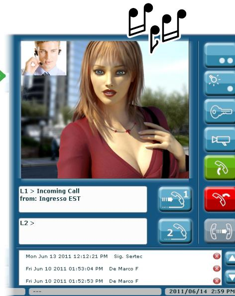
**RU** Если вызываемое устройство оборудовано камерой,зывающий пользователь отображается одновременно со звонком вызова, но без аудио.
