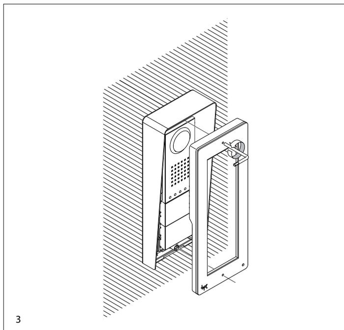
Снимите накладку (рисунок 1). Выкрутите верхний винты ослабьте нижний (рисунок 2 пункт А). **НЕ ОТКЛЮЧАЯ ВЫЗЫВНУЮ ПАНЕЛЬ** установите козырек рисунок 2 пункт В. Когда козырек установлен, закрутите оба винта и поставьте накладку как показано на рисунке 3.
